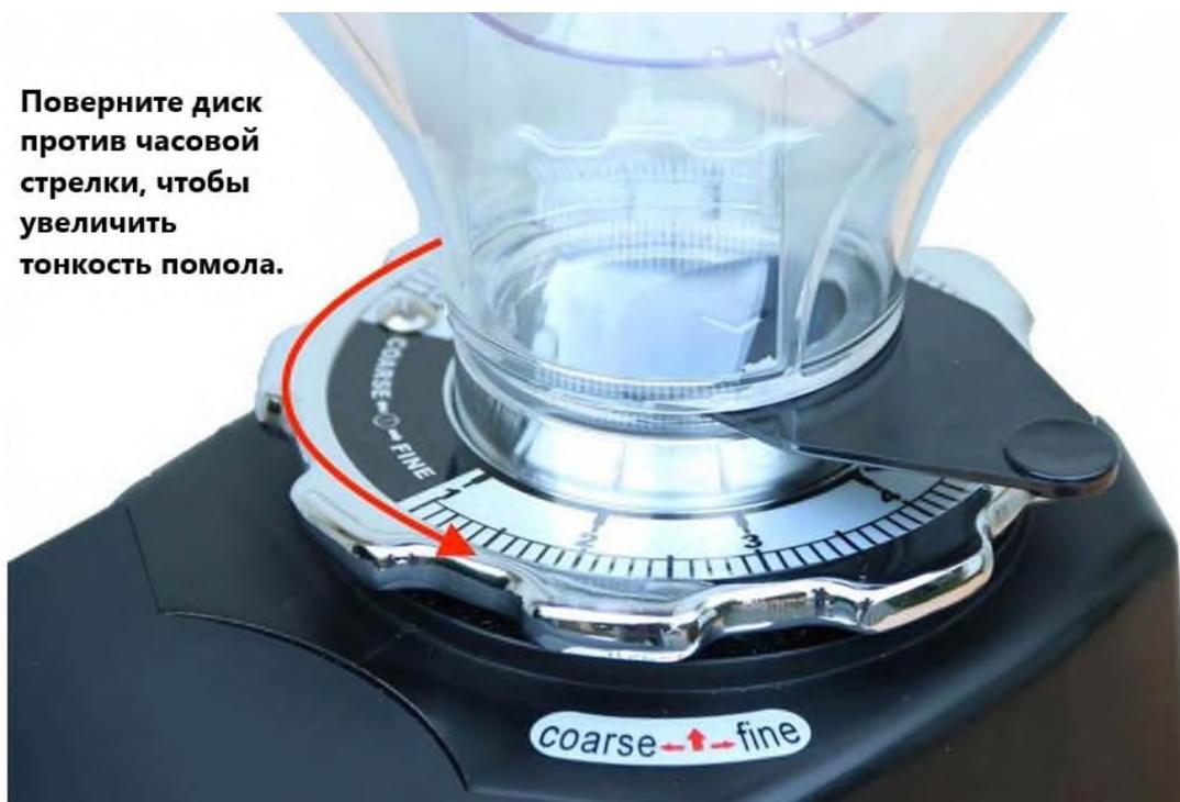
Диск остается в выбранном положении без фиксации на месте. Регулировку следует производить при включенном двигателе, желательно без кофе между измельчающими лезвиями.
