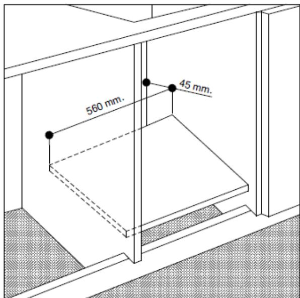
Стенки смежных шкафов кухонного гарнитура должны быть выполнены из жаропрочного материала. В частности, шкафы, обшитые шпоном, должны быть произведены с использованием клея, который может выдерживать температуры до 100°C.
