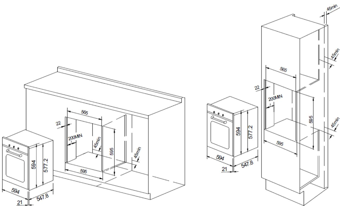
Для обеспечения соответствующего требованиям уровня вентиляции необходимо снять заднюю панель шкафа, в который устанавливается прибор. Лучше всего прибор устанавливать на два деревянных блока. Если же установка производится на плоскую поверхность, то в целях вентиляции необходимо оставить зазор 45 x 560 мм.
