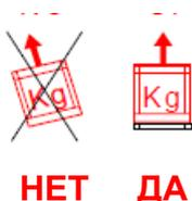
Рекомендуется перевозить оборудование только в вертикальном положении, в соответствии с маркировкой «ВЕРХ» и «НИЗ» на таре. Если холодильный стол, оборудованный встроенным конденсаторным блоком, находился в наклонном положении при перевозке, необходимо подождать, по меньшей мере, восемь часов перед тем, как начинать его использование. За это время масло растечется по всем элементам оборудования, система смазки восстановится, и оборудование можно будет запустить.
