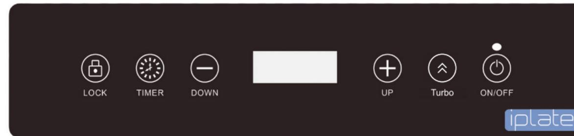
"ON/OFF" данной кнопкой производится включение плиты. Нажмите и удерживайте для включения
