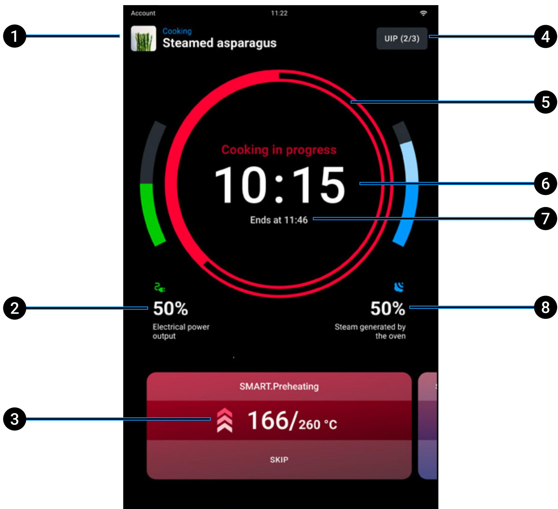
**5** **полоса завершения цикла приготовления:** цвет полосы интуитивно указывает на завершение цикла приготовления:
