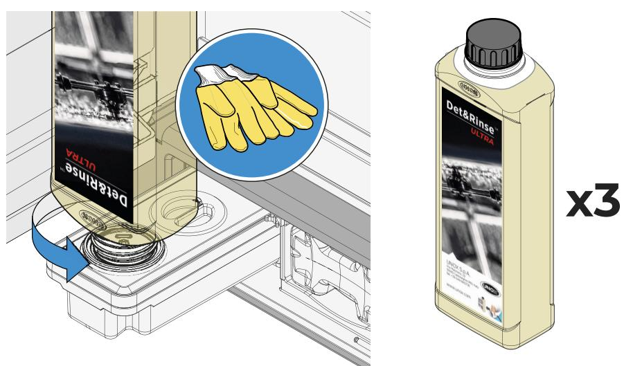
Повторить процедуру до достижения максимального допустимого уровня (3 литра = 3 флякона Det&Rinse™ Ultra UNOX), а затем вновь установить бачок до упора. Выбросить перчатки, не касаясь участков, на которых присутствует моющее средство.
