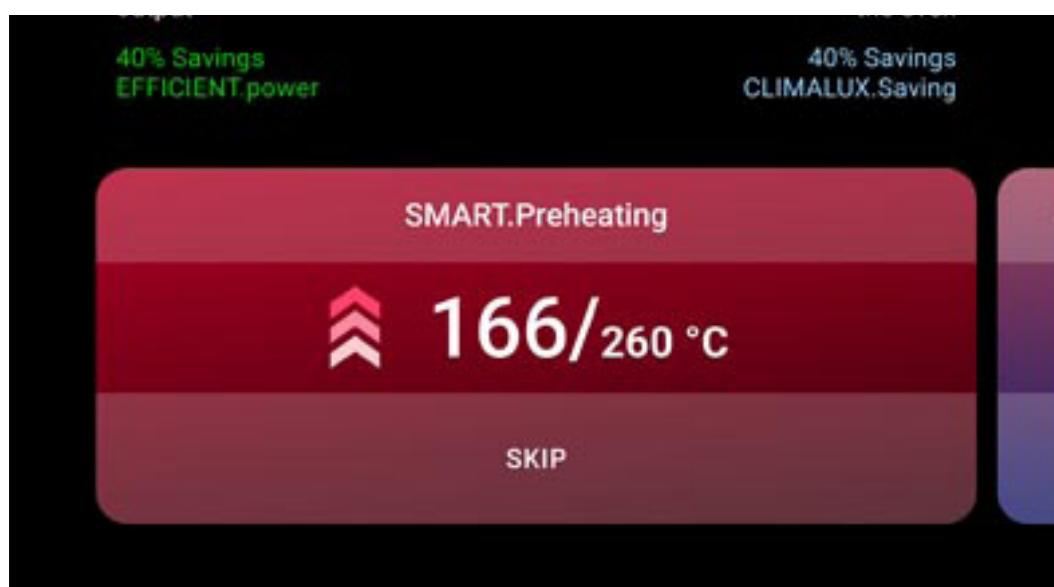
UNOX рекомендует использовать SMART.Preheating, автоматический подогрев, самостоятельно устанавливающий время и температуру подогрева; он учитывает рассеивание тепла при открытии дверцы и адаптирует камеру печи к новым параметрам при переходе от одного цикла приготовления к другому.
