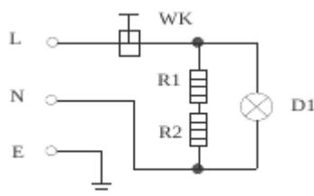
R1 , R2- элементы нагрева D1- Лампа нагрева WK1- Температурный контроллер
