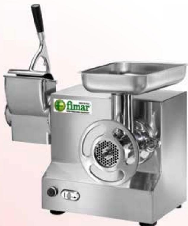
Carcassa e tramoggia in acciaio inox - gruppo macinazione in acciaio inox completamente estraibile - bocca ingresso carne ø 52 mm - inversione di marcia - riduttore con ingranaggi a bagno d'olio - in dotazione sistema enterprise con piastra inox (fori ø 6 mm) e coltello inox autoaffilante.
