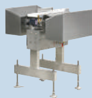
BF - Сбрасывающая планка (режекция в обе стороны)
