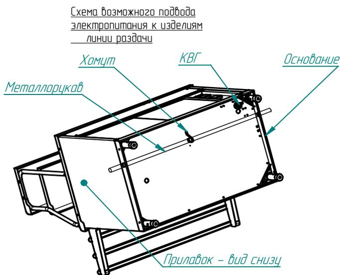
В основаниях изделий линии раздачи введено сквозное отверстие диаметром 29,5 мм и поддерживающие хомуты для возможности проведения металлоручкава с питающими кабелями сквозь все изделия линии раздачи.
