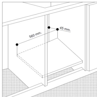
Стенки смежных шкафов кухонного гарнитура должны быть выполнены из жаропрочного материала. В частности, шкафы, обшитые шпоном, должны быть произведены с использованием клея, который может выдерживать температуры до 100 °С.
