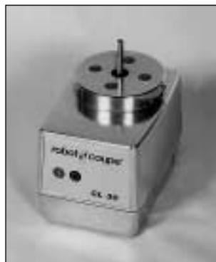
1) Поставьте блок двигателя перед собой, установите рабочий отсек из нержавеющей стали на блок двигателя, выходная воронка при этом находится с правой стороны.
