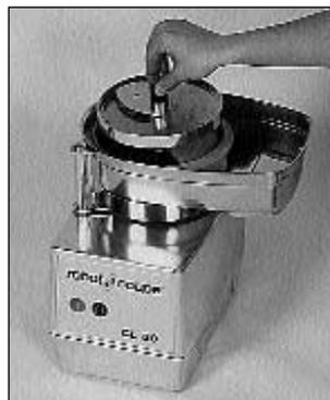
Установите затем соответствующий диск-измельчитель и завинтите крыльчатую гайку на валу двигателя для блокировки диска-измельчителя.
