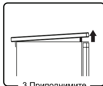
3. Приподнимите верхнюю крышку спереди и установите упор.
