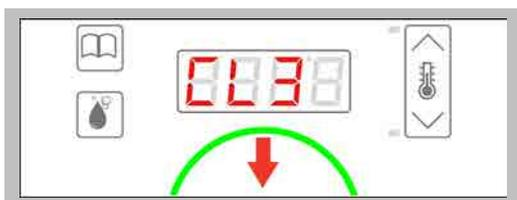
Быстро нажмите устройство C-Dial, чтобы запустить процесс очистки.
