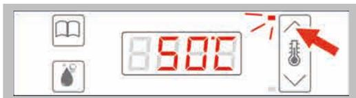
Выберите экранную кнопку 'Предварительный разогрев', чтобы предварительно разогреть рабочую камеру после запроса.
