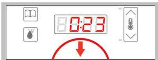
Быстро нажмите устройство C-Dial, чтобы остановить процесс готовки.
