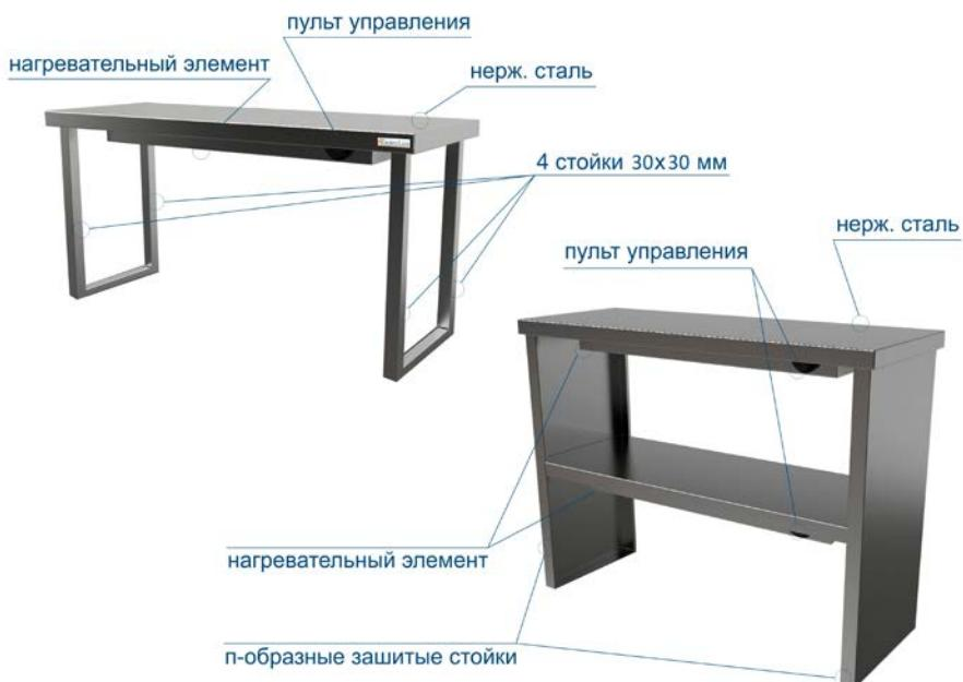
Полка тепловая с ИК-подогревом представляет собой полку (полки) с установленными инфракрасными нагревательными элементами и пультом управления с кнопкой включения, терморегулятором (однозонным), световым индикатором, которые установлены на 4 стойки из профиля 30х30мм (ПНТО) или на 2 защищые стойки (ПНТП). Также дополнительно возможна установка подсветки. Полка предназначена для настольной установки.
