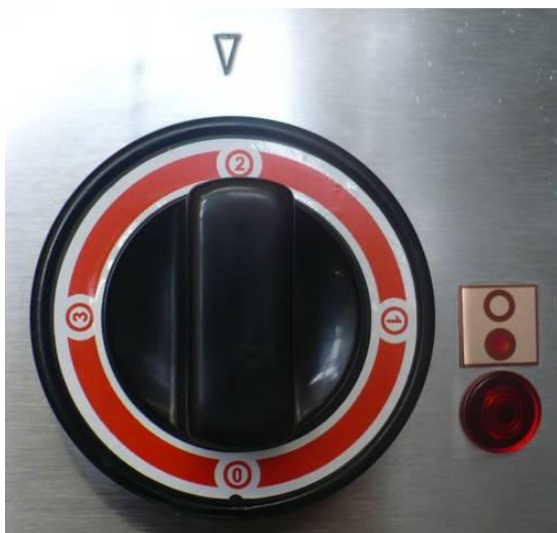
Рис. 6 Положение ручки термостата без нагрузки.
