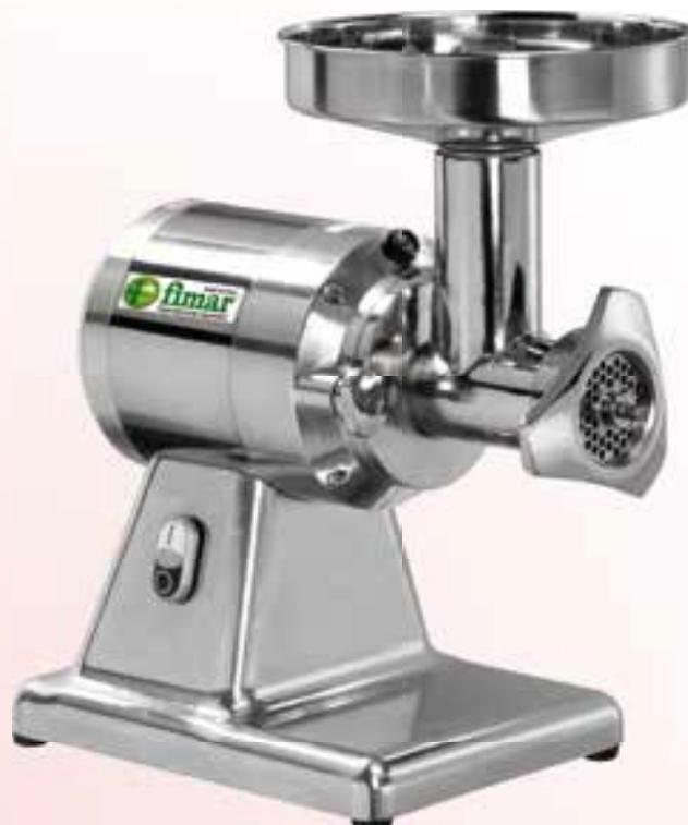
🇮🇹 Carcassa in alluminio lucidato con trasmisso in acciaio inox - gruppo macinazione in acciaio inox completamente estraibile - bocca ingresso carne ø 52 mm - riduttore con ingranaggi a bagno d'olio - in dotazione sistema enterprise con piastra inox (fori ø 6 mm) e coltello inox autoaffilante.
