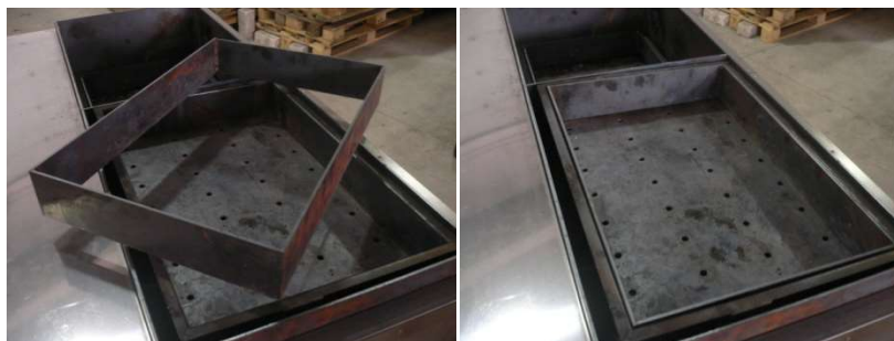
Защитный экран из стали 5 мм.
