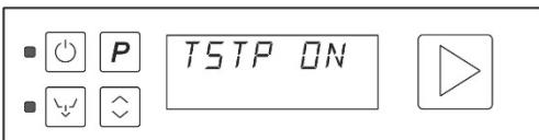
**При настройке на “вкл.” = минимальная температура ополаскивания** соответствует настроенной (см. температуру бойлера выше), вне зависимости от температуры поступающей воды; номинальная продолжительность цикла может увеличиваться на несколько секунд.
