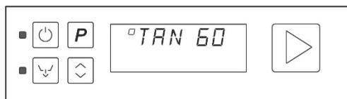
**Внимание:** указанная на дисплее температура в баке и в бойлере может отличаться от действительной на несколько градусов, особенно на промежуточных этапах (сразу после подачи воды FILL, после окончания рабочего цикла и т.д.) из-за тепловой инерции температурных датчиков.
