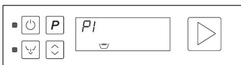
Подождите, пока на отобразится **P1-END**, и пока индикатор **L2** не изменит цвет с синего на зеленый; при необходимости нагрев воды в баке включится до достижения предусмотренной температуры. Продолжительность данного этапа может меняться в зависимости от температуры водопроводной воды и в случае однофазного подключения (если оно предусмотрено, зависит от модели).
