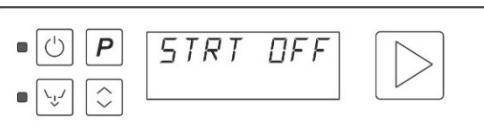
Если она настроена на "вкл.", то цикл запускается при закрытии дверцы/капота.
