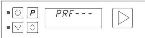
При включении электрической панели на дисплей выводится тип посудомоечной машины (PRF 400, PRF 500, CAPOTE.....), а следом за ним - установленная версия и ревизия прошивки.
