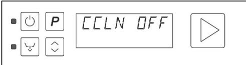
Предусматривает использование чистой воды **в каждом цикле мойки**. При выполнении каждого цикла моечная вода полностью сливается и заменяется чистой водой, поступающей из ополаскивания.
