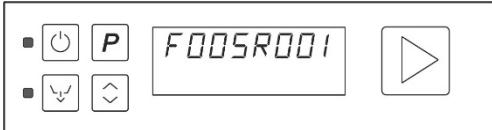
Если машина уже под напряжением, то при нажатии кнопки ВКЛ./ВЫКЛ. сразу отобразится установленная версия и ревизия прошивки.
