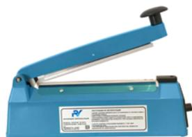
Аппараты предназначены для упаковки продукции в пакеты. Принцип действия заключается в пропускании электрического импульса через нагреватель, который формирует сварной шов.
