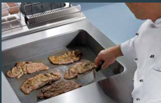
«Сухая» жарка (агрегат используется как плита контактной жарки)
