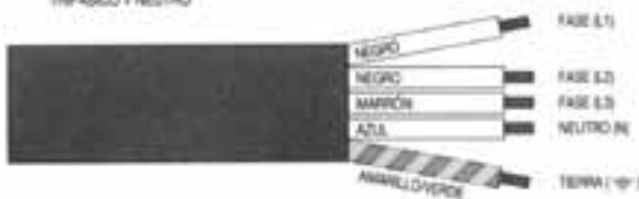
400 VOLTOS TRIFÁSICO + NEUTRO
