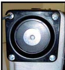
Снимите крышку камеры воздушного фильтра
