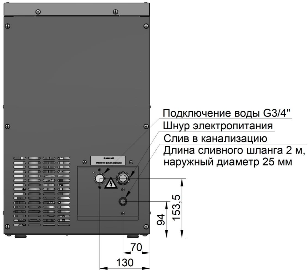
Рис. 5 Схема подключения льдогенератора
