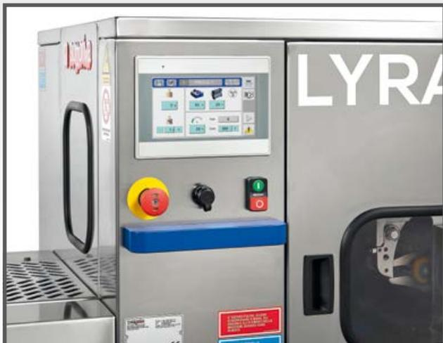
Particolare del pannello comandi delle versione elettronica con touch screen e PLC a 50 programmi memorizzabili.
