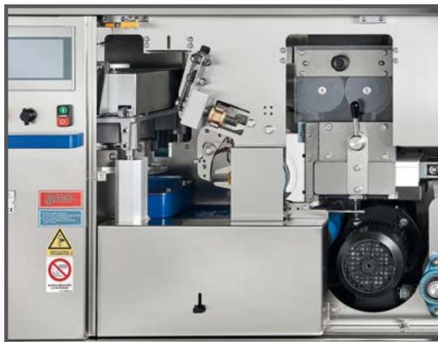
Il sistema di spezzatura a stella che, per la particolare concezione costruttiva, non stressa la pasta migliorando il risultato del prodotto finito. Lo sfarinatore posizionato tra la fase di spezzatura e la fase di arrotondatura permette un adeguato spolvero di farina sul prodotto quando si devono spezzare e arrotondare paste particolarmente appiccicose. I particolari materiali usati permettono alla macchina il funzionamento senza olio di lubrificazione.
