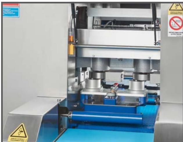
Particolare della camera di arrotondatura a doppio effetto, regolabile a seconda del peso da produrre per un migliore risultato del prodotto finito. Il nastro modulare in plastica sottostante la camera di arrotondatura è di estrema robustezza date le caratteristiche del materiale usato. Il contrappeso del sistema di arrotondatura e la movimentazione a cinghie rende la macchina particolarmente stabile durante la fase di arrotondatura.
