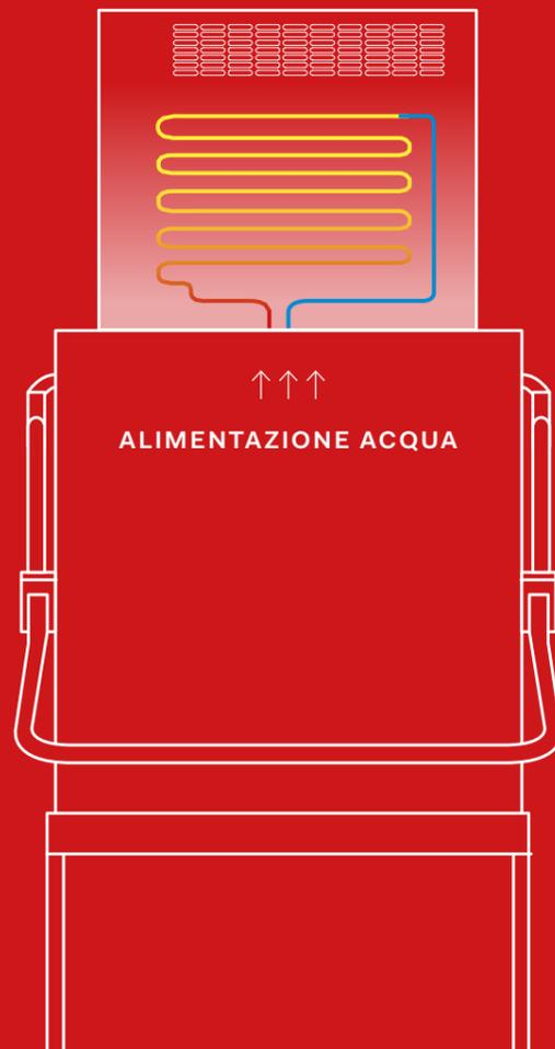
Questo dispositivo aiuta a ridurre il vapore, **creando un ambiente di lavoro più salutare**. I vapori condensati vengono utilizzati per scaldare l'acqua in ingresso nella macchina, con una significativa riduzione dei consumi di energia. La riduzione dei vapori nella vasca di lavaggio contribuisce ad accelerare l'asciugatura di piatti e bicchieri.
