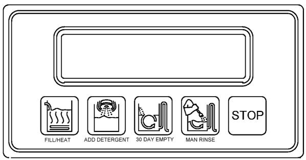
ЗАПОЛНЕНИЕ /НАГРЕВАНИЕ ДОБАВЛЕНИЕ МОЮЩЕГО СРЕДСТВА ОПОРОЖНИТЬ ПОСЛЕ 30 ДНЕЙ РУЧНОЕ ПОЛОСКАНИЕ стоп
