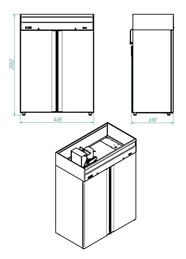
Шкаф холодильный типа ШХ-1,0 (ШХн-1,0; ШХс-1,0) с верхним расположением агрегата предназначен для хранения пищевых продуктов в охлаждённом или замороженном состоянии на предприятиях общественного питания и торговли.
