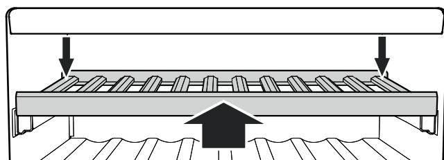
Придавите деревянную полку до конца назад, чтобы она спереди вошла в зацепление.
