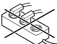
Не используйте автономные инверторы (преобразователи постоянного тока в переменный или трехфазный ток) либо энергосберегающие разъемы. Опасность повреждения электронного оборудования!
