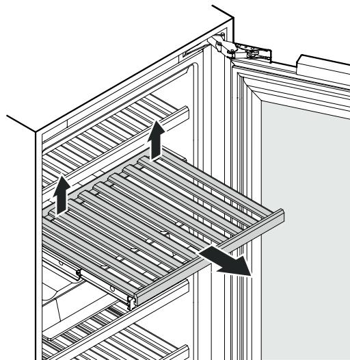
Поднимите деревянную полку в задней части справа и слева (выведите ее из зацепления) и вытащите, потянув вперед.
