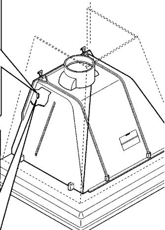
IT - Fissaggio cappa (3, 4). Montaggio tubo d'aspirazione (5).
