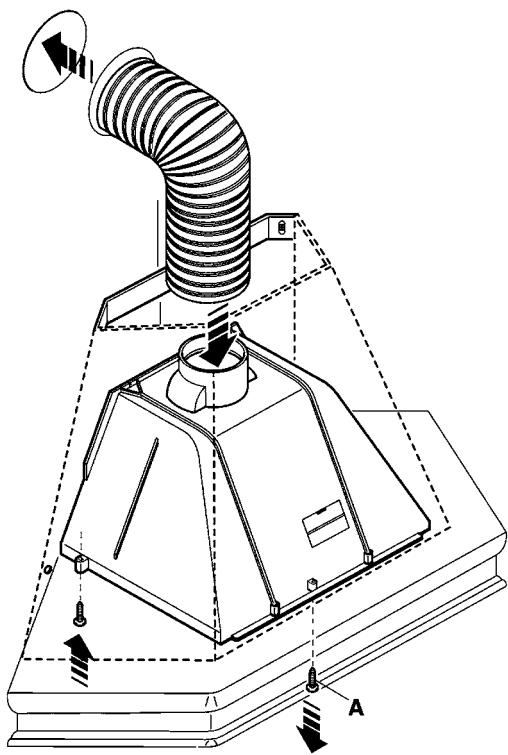
IT - Fissaggio camino (6, 7). Montaggio filtro carbone attivo di serie:
