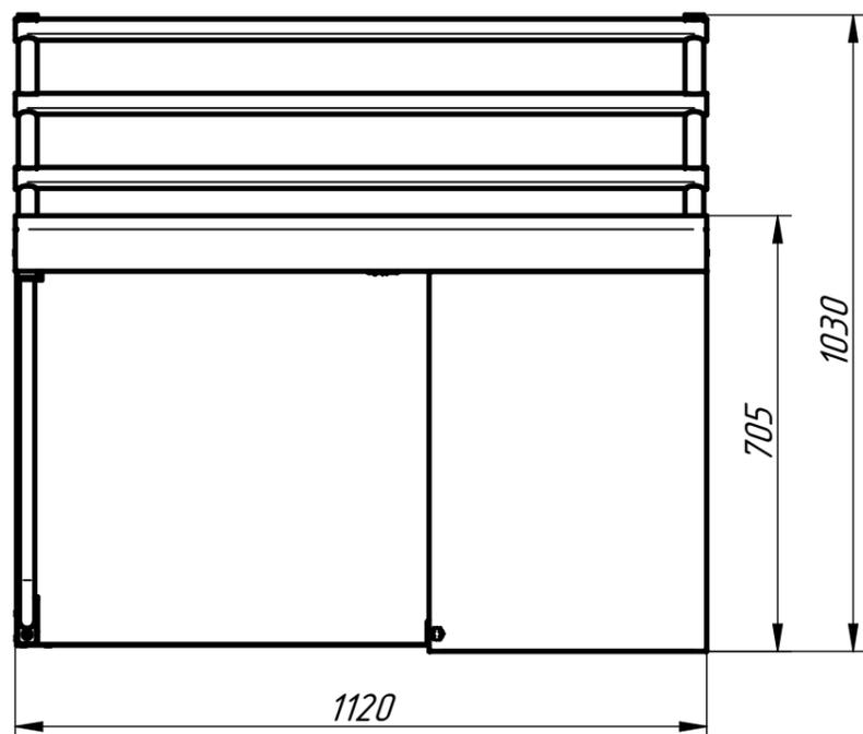
**Кассовая кабина** предназначена для установки на нем кассового аппарата и расчета с потребителями. Внизу имеется дополнительная полка и розетка 230В для подключения кассового аппарата. Путем несложного монтажа можно установить кассовую кабину как в левом, так и в правом исполнении. Направляющие для подносов входят в комплект поставки. Прилавок имеет регулируемые по высоте ножки.
