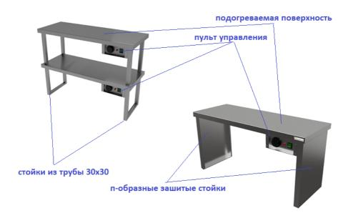
Изделие представляет собой полку (полки) с подогреваемой поверхностью (подогрев за счет гибкого тэна, расположенного во внутренней части полки) и пультом управления с кнопкой включения, терморегулятором, световым индикатором. Полки установлены на 4 стойки из профиля 30х30мм (ПНТО) или на 2 зашитые стойки (ПНТП). Также опционально возможна установка подсветки. Полка предназначена для настольной установки.
