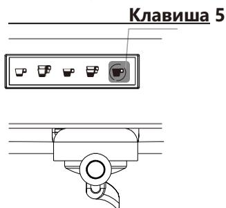
Держите клавишу нажатой в течение 5 секунд, пока не начнет мигать светодиодный индикатор, и на дисплее (при наличии) не появится сообщение "program select in 30s" (выберите программу в течение 30 секунд), (сначала появится счетчик доз, держите клавишу 5 нажатой).
