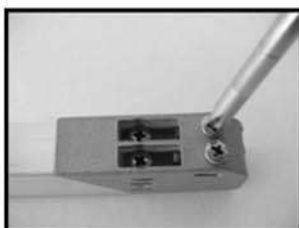
Отвинтите и удалите запаечные струны
