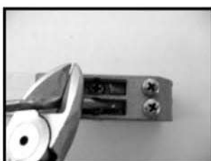
Натяните струны с помощью плоскогубцев
