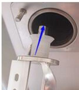
4. Установка вытянутого клапана: смажьте уплотнительные кольца вытянутого клапана, установите их в гнездо клапана. Смажьте клапаны и вставьте их в разгрузочную дверцу, следя за тем, чтобы квадратный вырез клапана совпадал с прямоугольным отверстием на передней дверце.
