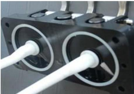
7. Вставьте собранную дверцу на четыре штыря на передней панели и крепко затяните с помощью фиксирующих винтов.
