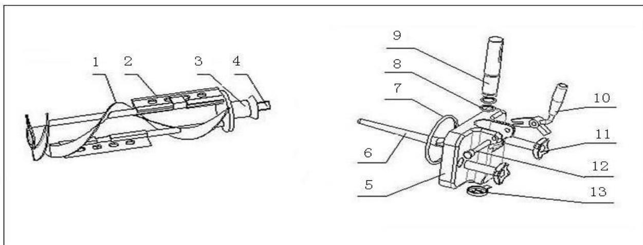
1. Венчик 2. Лопасты 3. Уплотнения 4. Вал 5. Разгрузочная дверца 6. Вал венчика 7. О-образное уплотнительное кольцо разгрузочной дверцы 8. О-образное уплотнительное кольцо вытянутого клапана 9. Вытянутый клапан 10. Ручки 11. Фиксирующий винт 12. Стержень 13. Крышка клапана.
