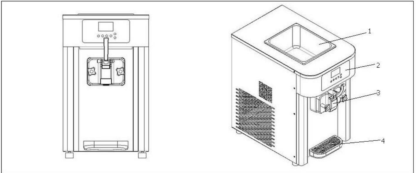
1. Бункер для смеси 2. Дисплей 3. Разгрузочная дверца 4. Поддон для стекания капель
