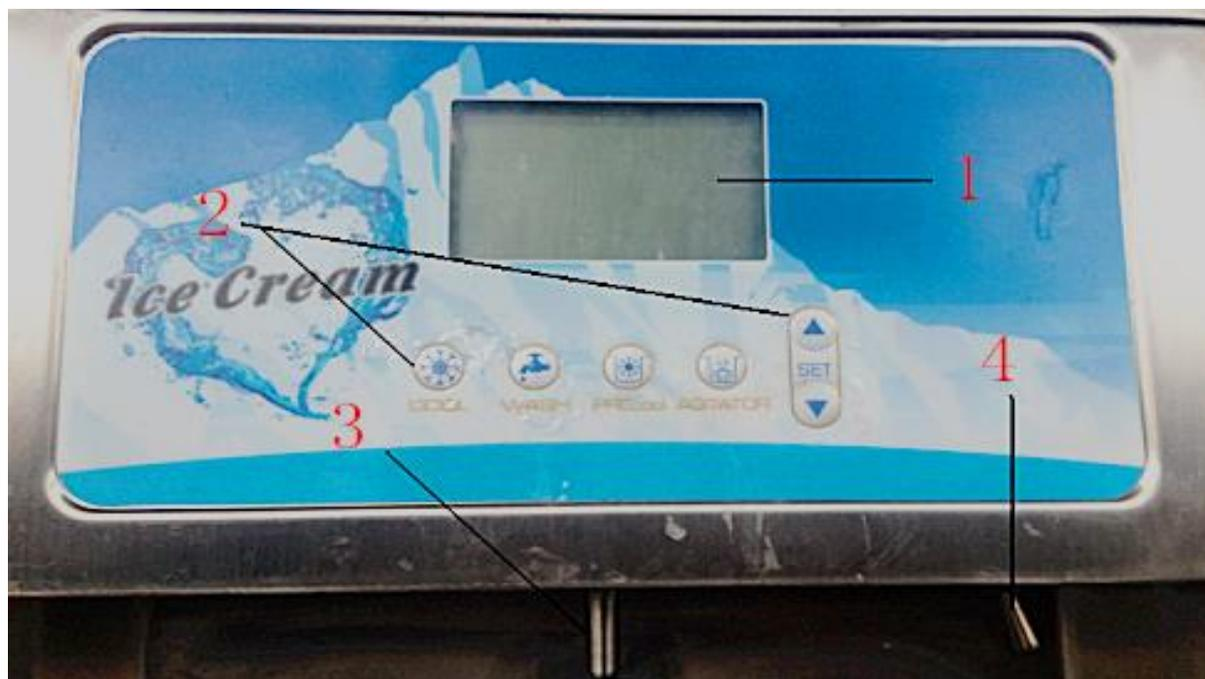
1. Дисплей    2. Рабочие кнопки    3. Кольцевой выключатель    4. Выключатель питания
