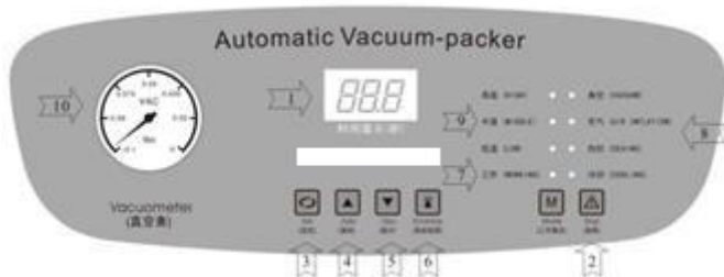
Рис. 6 Электронная панель управления оборудования.
