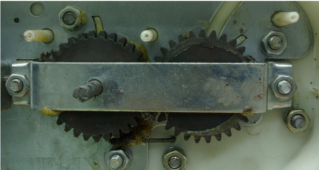
Используя молибден дисульфидную смазку, производите тщательную смазку вала, шестерен и муфты:
