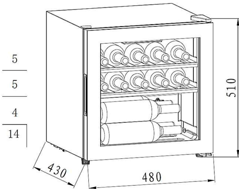
Винный шкаф снабжен съемными полками для удобного хранения вина. Вместимость данной модели винного шкафа составляет 14 бутылок (стандартные бутылки формы «Бордо», объем 750 мл).
