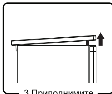
3. Приподнимите верхнюю крышку спереди и установите упор.
