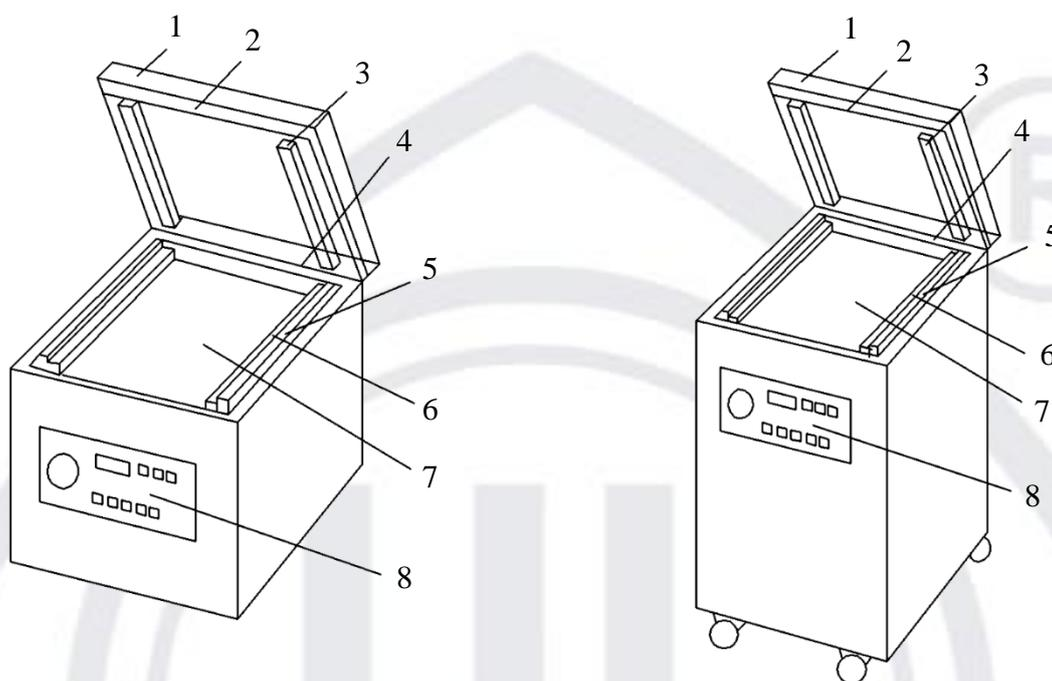
1. Крышка из оргстекла 2. Уплотнитель крышки 3. Силиконовая планка 4. Концевой выключатель 5. Прижимная планка 6. Планка запайки 7. Вакуумная камера 8. Панель управления.
