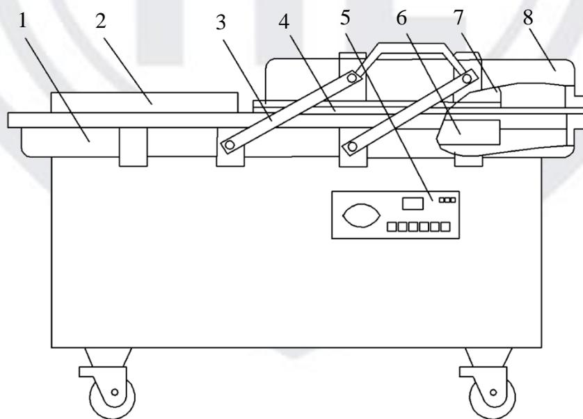
1. Рабочая камера 2. Планка запайки (Пластина) 3. Соединительный шток 4. Уплотнитель крышки 5. Панель управления 6. Устройство для запайки (двухкамерное) 7. Прижимная планка 8. Крышка вакуумной камеры
