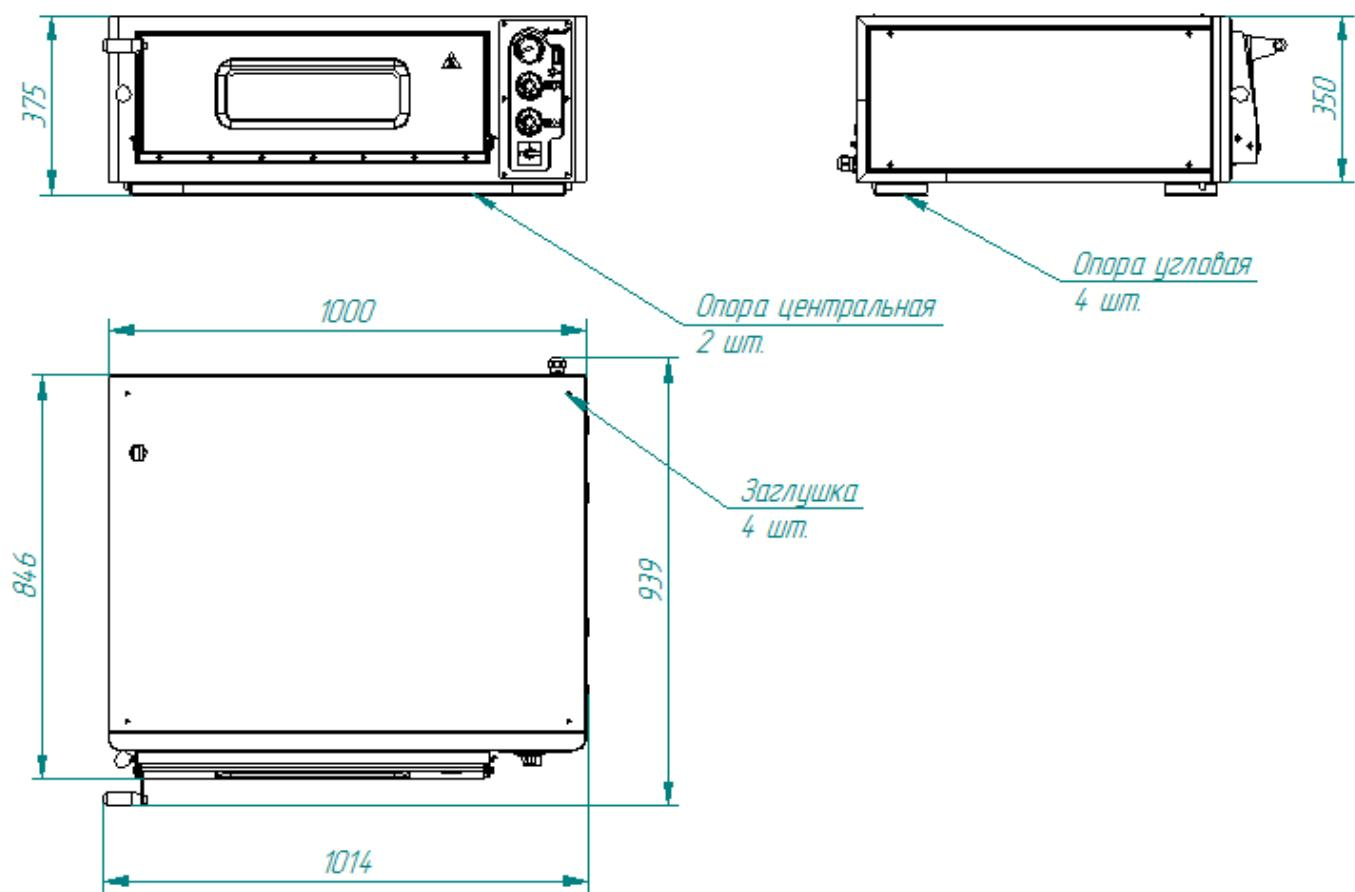
Рис.2 Общий вид печи ПЭП-4х2
