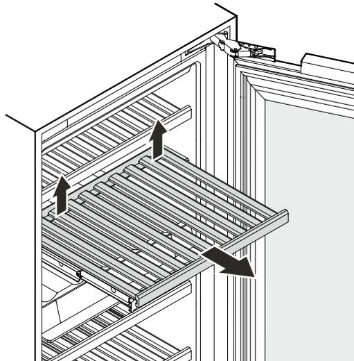
Поднимите деревянную полку в задней части справа и слева (выведите ее из зацепления) и вытащите, потянув вперед.
