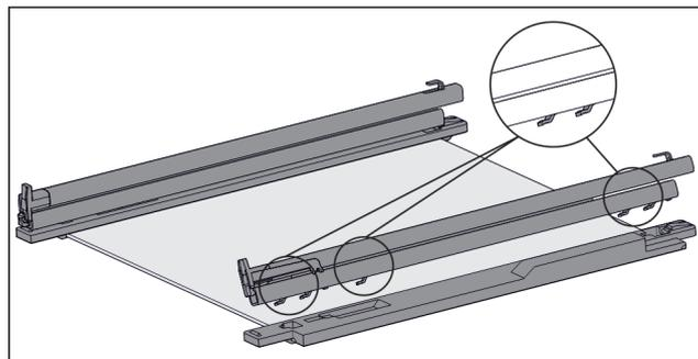
Fig. 59 Стеклопластина с направляющими и крепежными элементами
