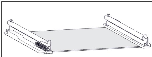
Fig. 62 Узел амортизатора
