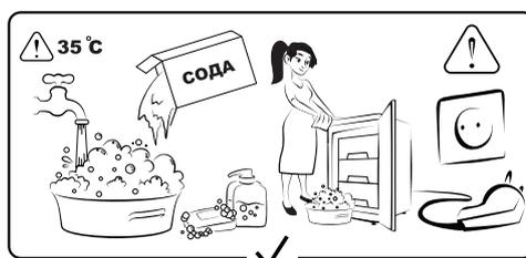
5.6 В целях устранения специфического запаха, который может возникнуть в результате длительного хранения неработающего морозильника в закрытом состоянии, в первый месяц эксплуатации еженедельно промывайте внутренние поверхности и комплектующие изделия морозильника и проветривайте в соответствии с п. 5.5.
