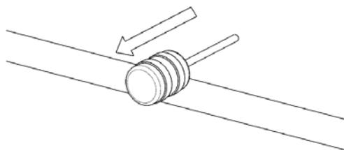
Отверстие для поступления воздуха управляется при помощи регулятора тяги воздуха, расположенного на панели под духовым шкафом. Чтобы открыть воздушную заслонку потяните ручку до упора на себя.
