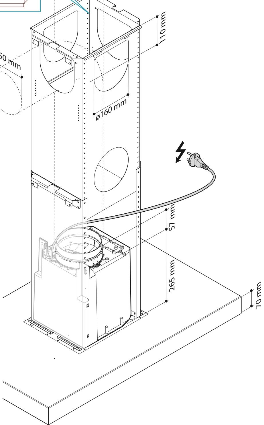
IT - Operazioni preliminari: separare traliccio superiore da traliccio inferiore (1). Rimozione filtri (2)+(3).
