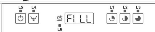
Начинается заполнение бака. При полном баке дисплей отображает по очереди "End" и последнюю выполненную программу (End/P1).
