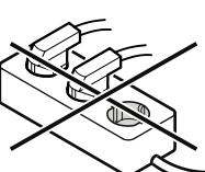
Не используйте автономные инверторы (преобразователи постоянного тока в переменный или трехфазный ток) либо энергосберегающие разъемы. Опасность повреждения электронного оборудования!
