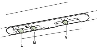
**L** Luces Enciende y apaga la instalación de iluminación.
