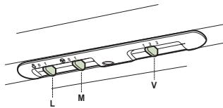
**L** Освещение Включает и выключает осветительное оборудование
